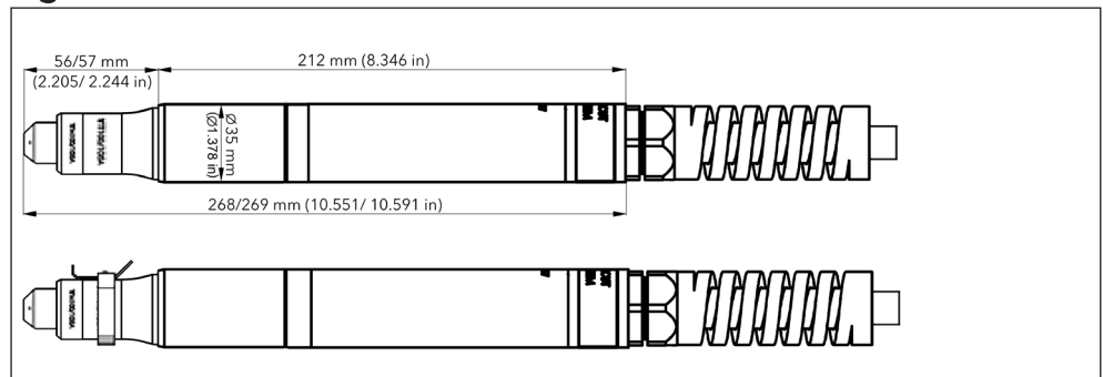
Fig. 7 FHT-EX®105TTSM torch dimensions
